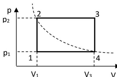
Так как участки 1-2 и 3-4 принадлежат изохорным процессам, то работа на этих участках не совершается.  $A_{12} = 0$  и  $A_{34} = 0$ . А работа, совершенная газом на 2-3 и 4-1 в координатах  $p - V$  может быть найдена графически, то есть как площадь под графиком. Учитывая, что на 2-3 газ расширяется,  $A_{23} > 0$ , а на 4-1 газ сжимается,  $A_{41} < 0$ . Значит:
